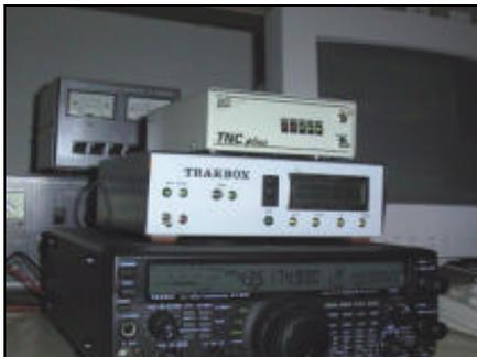
Figura 14: Equipamiento necesario para montar una estación de acceso al satélite.
